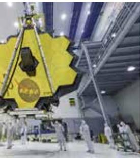
La mejor manera de hacer un telescopio realmente potente es construir un gran espejo. El telescopio espacial James Webb tiene el espejo más grande de este tipo en ser construido por la NASA, tan grande que no cabe dentro de un cohete sin plegarse. Juntos, los 18 segmentos de espejos hexagonales abarcan 6,5 metros.
