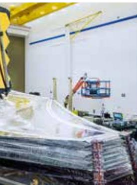
Los sensores del telescopio son tan sensibles que necesitan ser bloqueados de la radiación infrarroja del sol, la Tierra y la luna. El parasol de cinco capas es como tener una protección solar de 1 millón de SPF.
